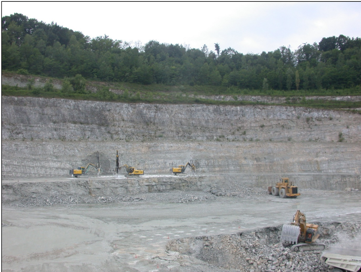
Figura 4.2 – Fronte lato NNO, struttura sinclinale simmetrica con asse immergente verso E a basso angolo (ripresa giugno 2014).
