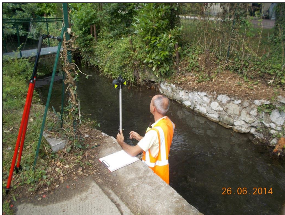
Foto 1: Rilievo sezione Torrente Acquanegra
